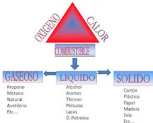
Fig. 5. Triángulo del fuego (Combustible, Comburente, Calor)
