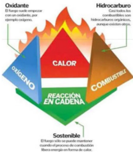
Fig.6. Tetraedro del fuego (Combustible, Comburente, Calor y Reacción en Cadena)
