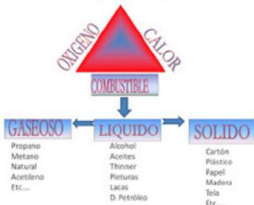
Fig. 5. Triángulo del fuego (Combustible, Comburente, Calor)
