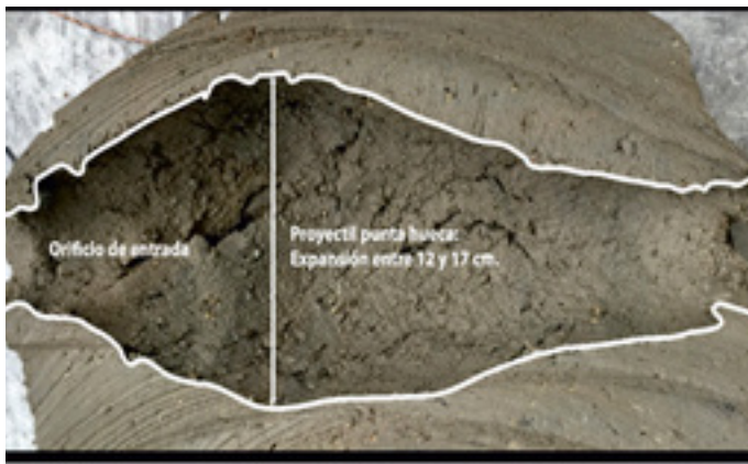
Imagen 6. Cuidado permanente producida por el impacto de un proyectil de punta hueca de calibre 9 x 19mm en un bloque de arcilla. Fuente: https://scielo.isciii.es/scielo.php?script=sci_arttext&pid=S1135-76062017000100006
