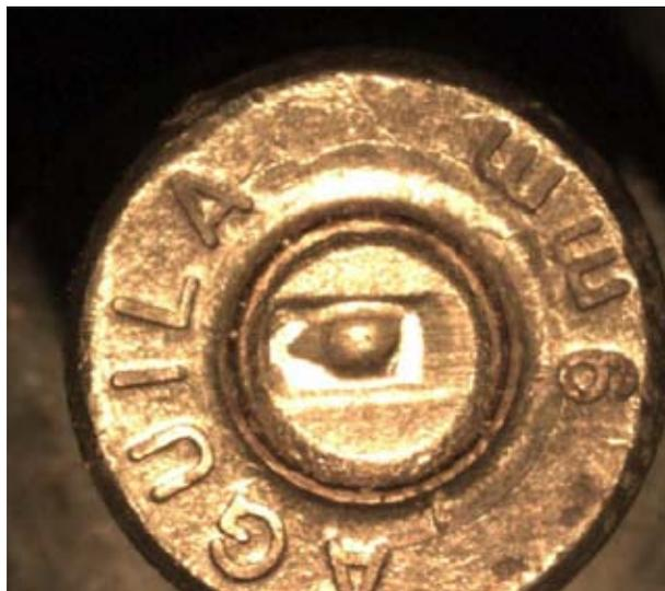
En las imágenes anteriores es posible ver la marca comercial, el calibre y algunas marcas que se buscan, como la recámara, el percutor, el proyector. Es importante resaltar que existe una serie de características especiales visibles solamente con microscopio.
